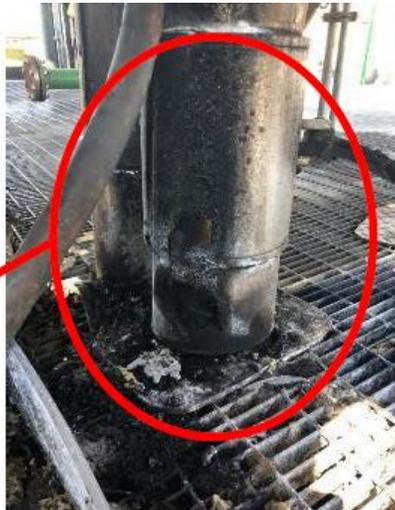
Détection d'une fuite sur soudure
